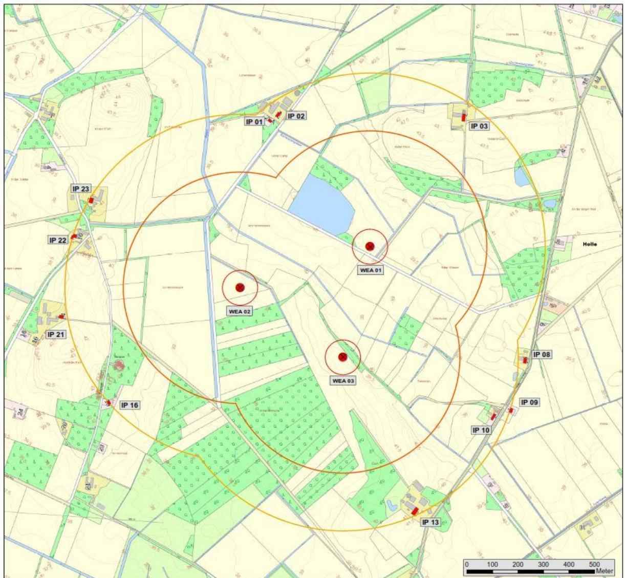
**Abb. 7** Lage der umliegenden Wohngebäude zum geplanten Windpark gemäß Gutachten zur Opt. Bedr. Wirkung (gelbe Linie entspricht 3-facher Anlagenhöhe, orange Linie entspricht 2-facher Anlagenhöhe) (Dense und Lorenz, 2018)
