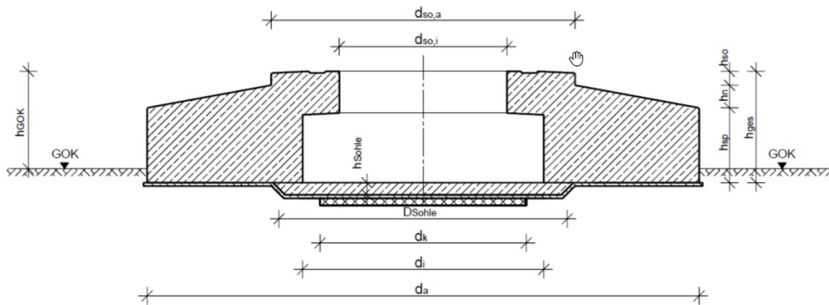
Abb. 2: Geplante Ausführung des Flachfundaments (Zeichnung: Enercon)
